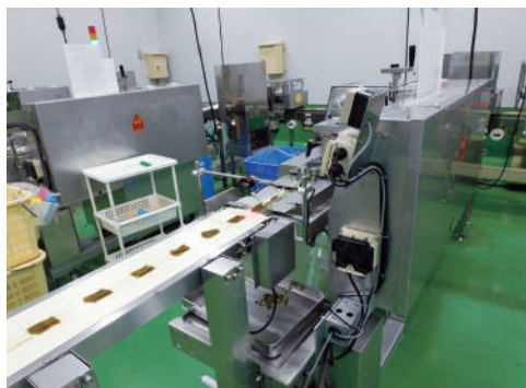
個包装されベル状態でトコンベアでX線装置まで移送。X線装置で、量目や噛みこみなどを自動チェック
