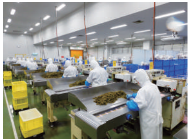
開梱室で槽を開梱して、使用する分だけ台車の上に載せて中に持ち込み、手作業で個包装を行っている。PB商品は量目やパッケージの種類が多種多様で、手作業での対応が必要になっている
