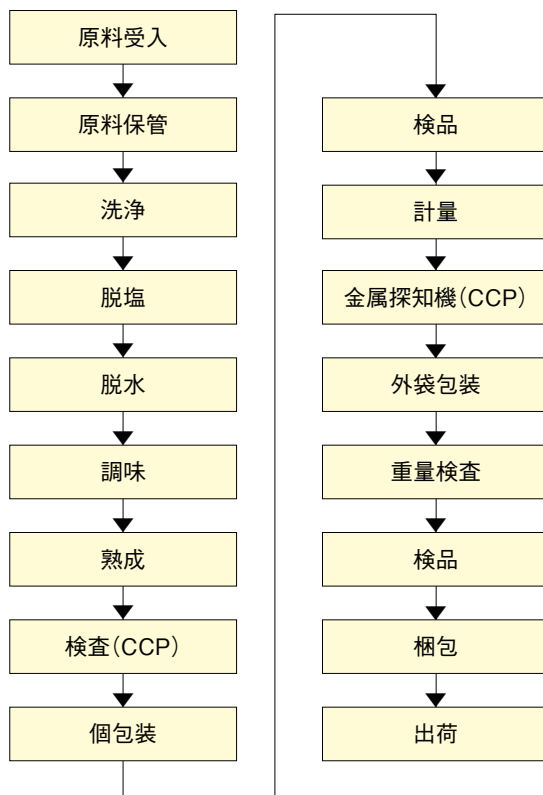
図2 大植工場における調味工程、出荷までのフローダイアグラム
