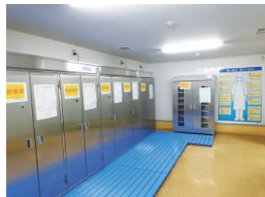
作業靴の保管庫はオゾン殺菌庫になっており、夜勤の終了と同時にスイッチを入れておけば自動的に作業靴の殺菌が行える
